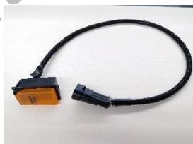
手动启动开关如上图所示，在安装过程中与连接器AMP282104-1相连，请观察线路是否有破损、漏线等情况。
